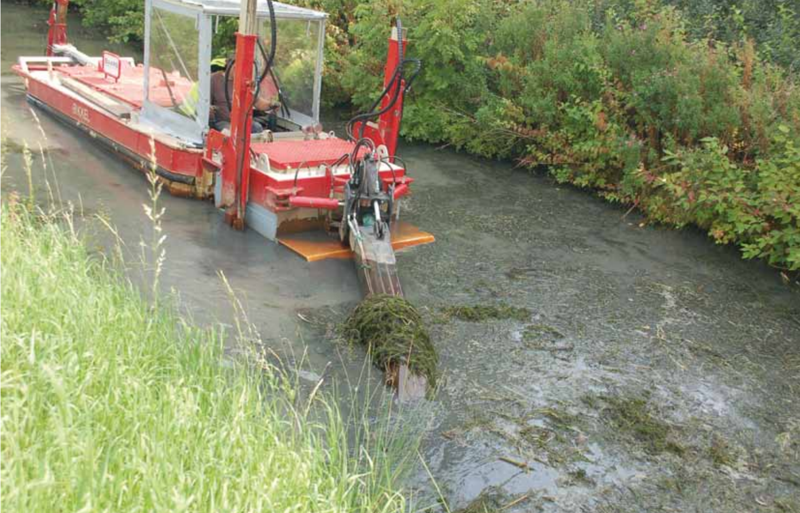
De hydroventurimethode wordt toegepast in de zomer en nazomer; dan hebben de waterplanten de meeste biomassa en drijfkracht. Vanaf het wateroppervlak worden ze met grijparm of korf uit het water gevist.
